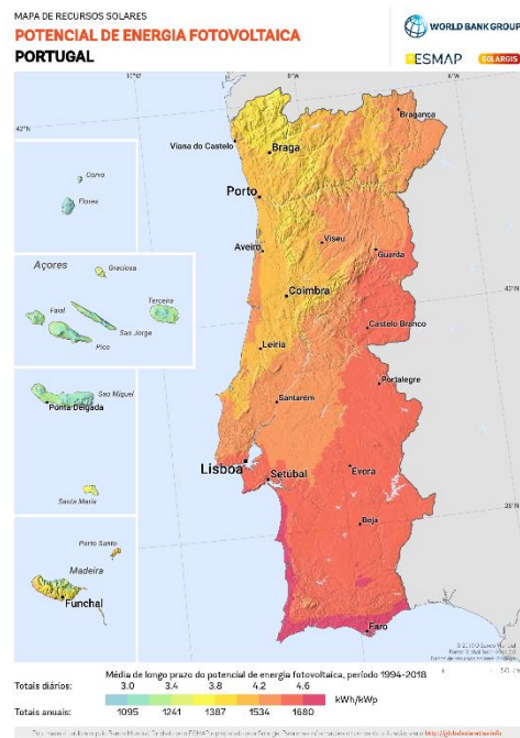
Figura 2.11 - Potencial de energia fotovoltaica em Portugal [20]
