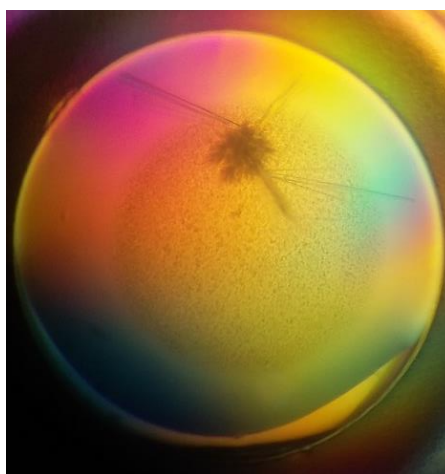
Figura 5.2- Cristais de PtpA obtidos a 4 °C, para ensaios de gota assente em solução precipitante 10% PEG 6K e 0,1 M HEPES pH 7.
