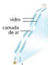
Figura 3.9 – Esquema do vidro duplo
