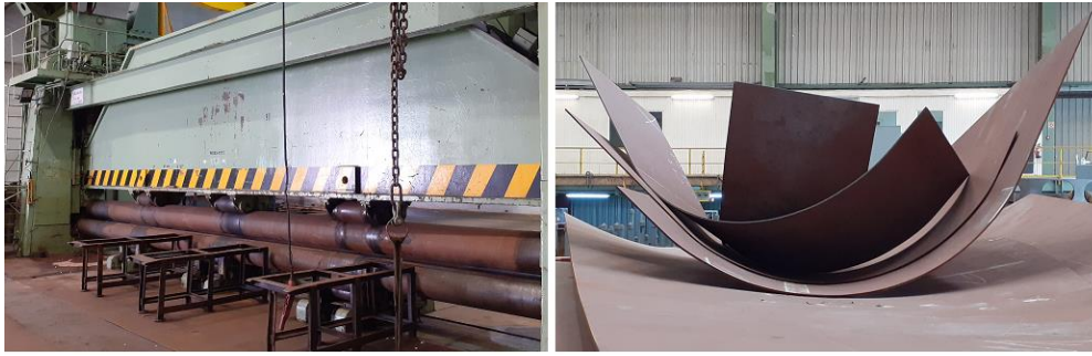
Figura 3.64 - Chapas enformadas através de calandra de 750 Ton (Fonte: West-sea)
