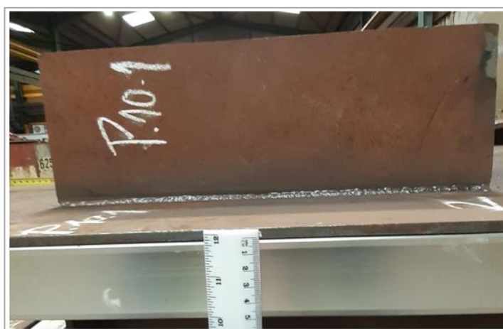
Figura 4.52 - Sem deformação por encurvadura da chapa principal (na longitudinal) do P.10.1
