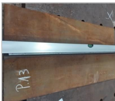
Figura 4.28 - Sem deformação da barra (na longitudinal) do P.13
