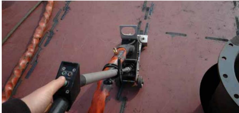
Figura 3.55 - Equipamento EFD Induction de desempenho por indução [37]
