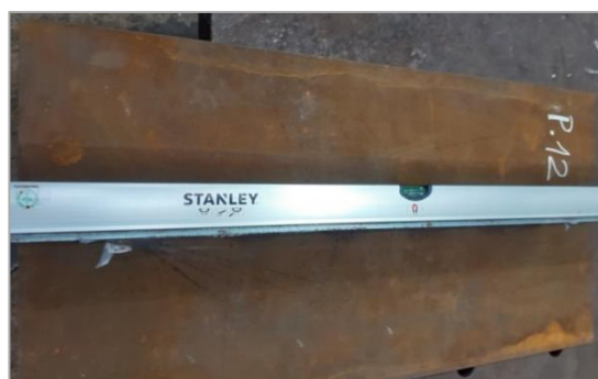
Figura 4.25 - Sem deformação por encurvadura da barra (na longitudinal) do P.12
