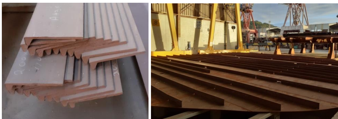
Figura 3.69 - Perfis estruturais ferros bolbo (à esquerda) e painel com longarinas pingadas (à direita) (Fonte: West-sea)
