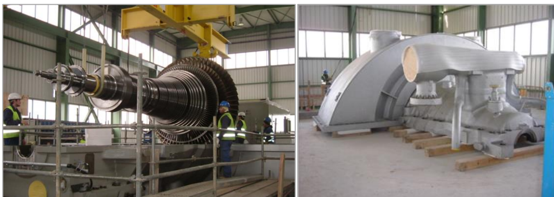
Figura 2.7 - Montagem de rotor da turbina (à esquerda) e casing superior (à direita)
