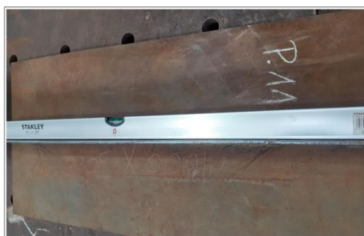
Figura 4.21 - Sem deformação por encurvadura da barra (na longitudinal) do P.11
