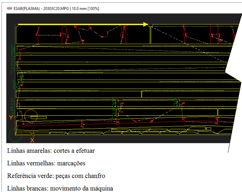
Figura 3.60 - Marcação de chapas e abertura de chanfros (Fonte: West-sea)
