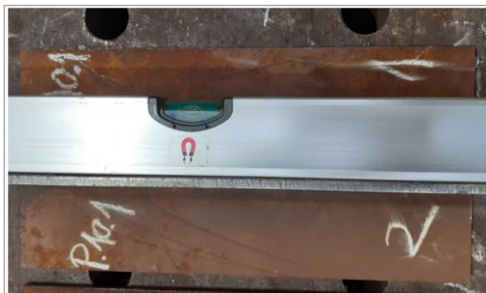
Figura 4.51 - Sem deformação por encurvadura da chapa menor (na longitudinal) do P.10.1
