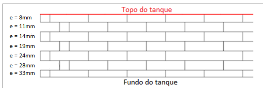
Figura 2.18 - Espessuras das virolas e respectivas seqüências de montagem de um tanque
