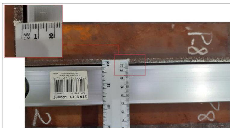
Figura 4.42 - Deformação por encurvadura da chapa menor (na longitudinal) do P.8
