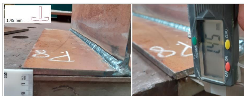
Figura 4.40 - Distorção angular (transversal) do P.8
