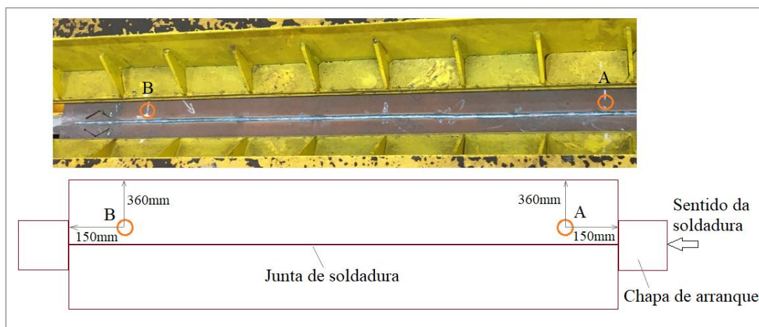
Figura 4.11 - Pontos de medição de temperatura A e B
