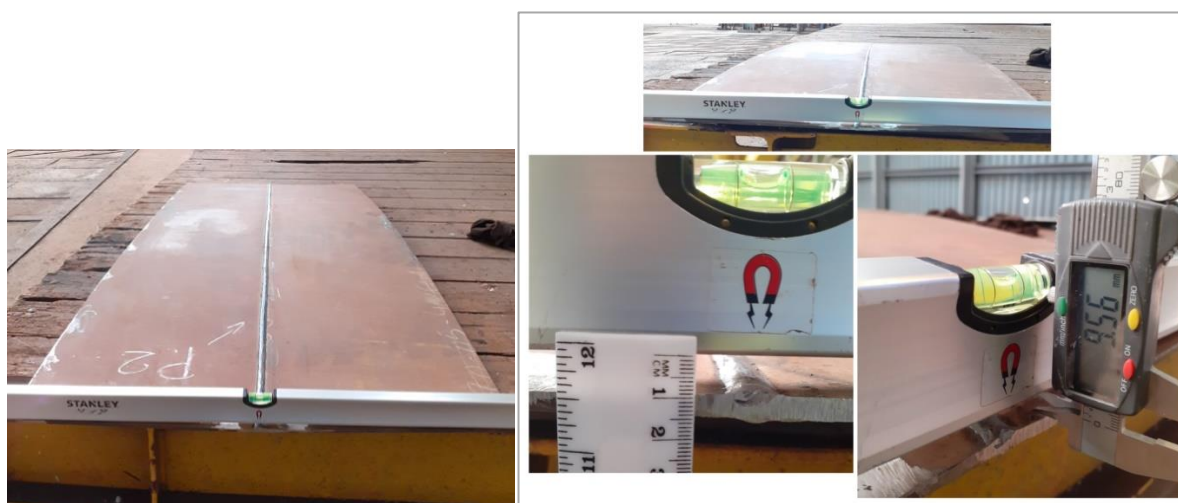
Figura 4.16 - Deformação angular (transversal) do P.2
