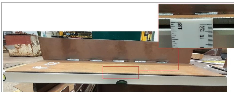
Figura 4.24 - Deformação por encurvadura (na longitudinal) do P.11
