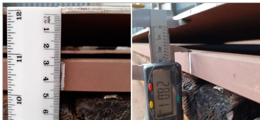
Figura 4.17 - Deformação por encurvadura (longitudinal) do P.2
