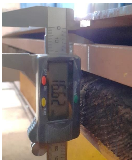
Figura 4.15 – Valor máximo obtido de encurvadura (longitudinal) no P.1
