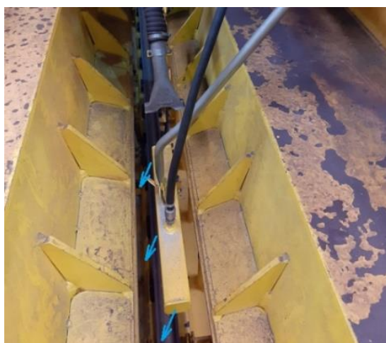
Figura 4.9 - Sistema de arrefecimento através de ar comprimido
