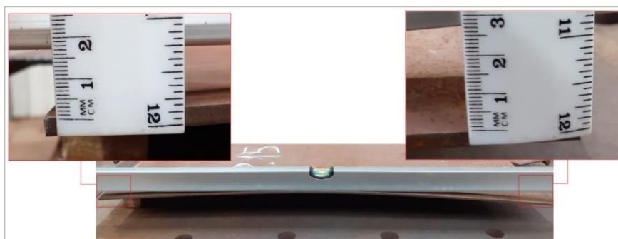
Figura 4.58 - Deformação por encurvadura (na longitudinal) do P.15
