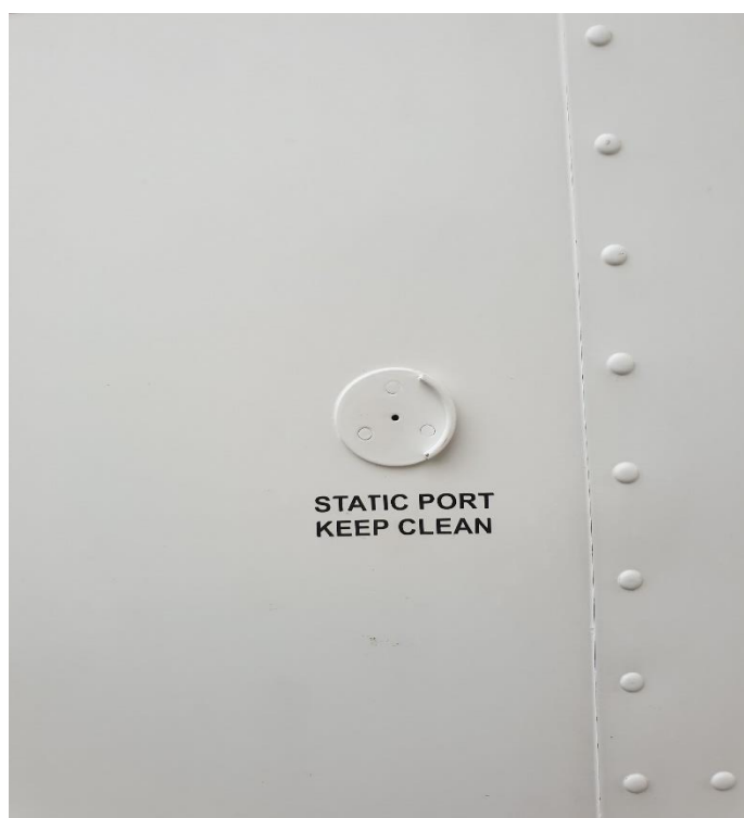
Figura 30- Design nº2 da tomada de pressão estática do Tecnam P2008 (tomada nº2)
