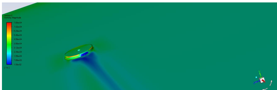
Figura 98- Perspetiva exterior da distribuição da magnitude de vorticidade através de contour para a tomada de pressão estática nº1 a 80 m/s
