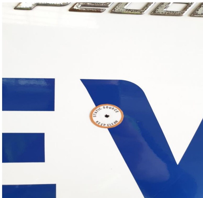
Figura 29- Design nº1 da tomada de pressão estática do Tecnam P2008 (tomada nº1)
