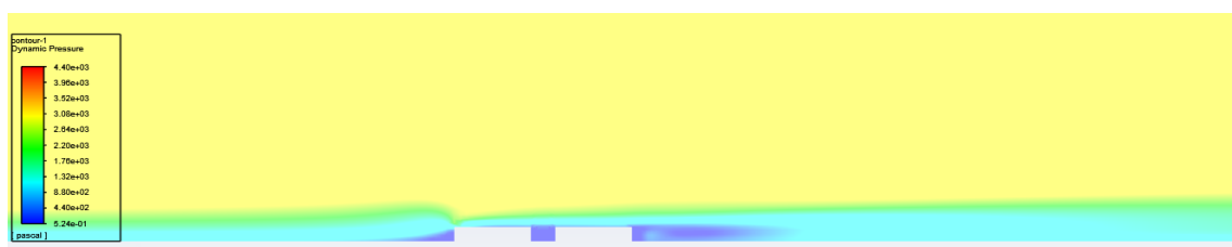
Figura 81- Distribuição bidimensional do campo de pressões dinâmicas através de contour para a tomada de pressão estática nº1 a 70 m/s
