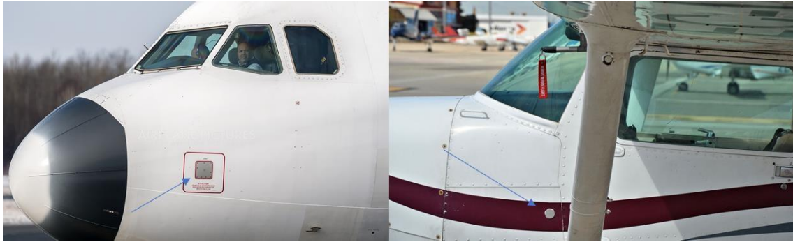
Figura 2- Posição da Tomada de Pressão Estática num Airbus A320 e num Cessna 152
