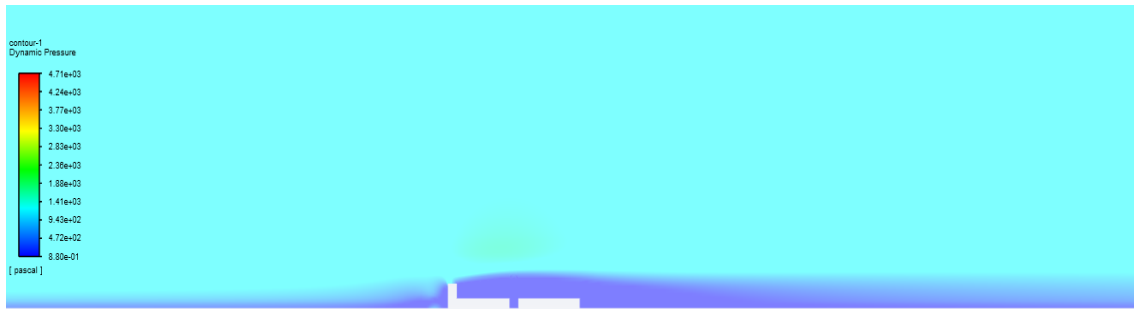
Figura 102- Distribuição bidimensional do campo de pressões dinâmicas através de contour para a tomada de pressão estática nº2 a 50 m/s
