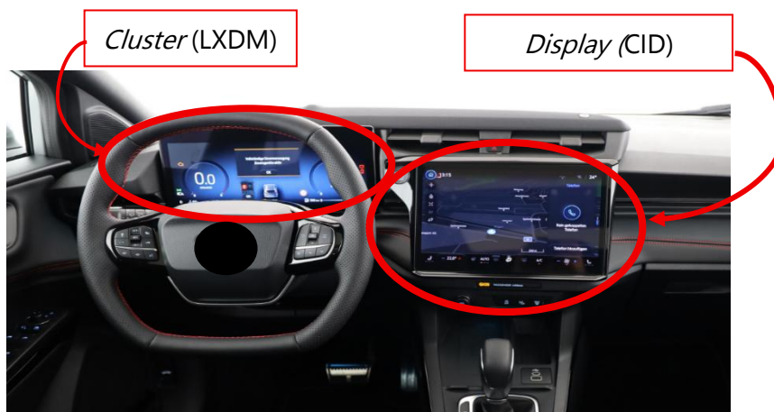
Figura 4.4 - Integração do Cluster e do Display no automóvel
