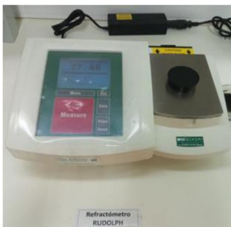
Figura 3.2: Refratômetro utilizado para determinar o Brix da amostra.
