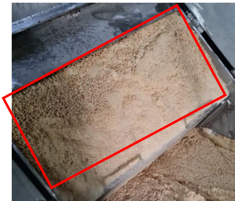
Figura 4.10: Porta de amostragem do Silo, com elevada concentração de torrões.
