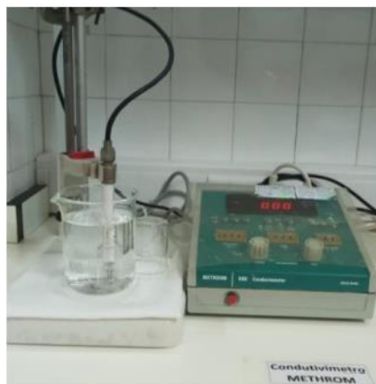
Figura 3.4: Condutivímetro utilizado para determinar a quantidade de cinzas da amostra.
