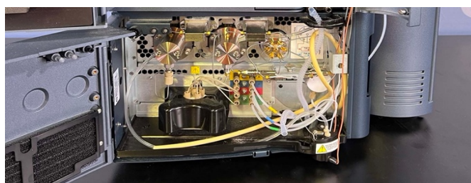
Figura 2.3 - Bomba quaternária de solventes (adaptada de [31])
