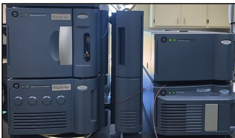
Figura 2.1 - Módulos do sistema de UHPLC-MS (adaptada de [29])
