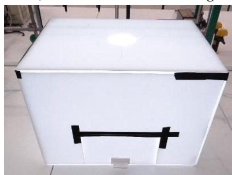
Figura 3.4 - Estrutura construída para fotografar as amostras de carne.
