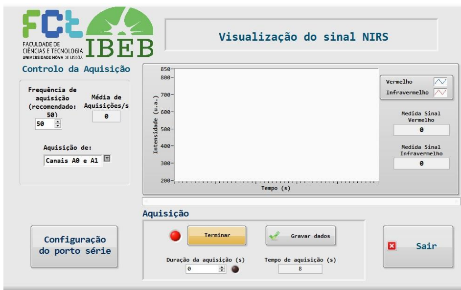
Figura 5.18 Interface da aplicação informática NIRSAq que recebe os dados provenientes do microcontrolador através duma ligação USB.
