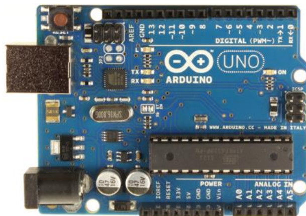
Figura 5.16 Placa de desenvolvimento Arduino Uno com microcontrolador ATmega328. [40]
