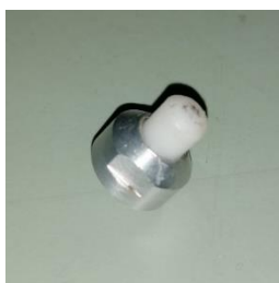
Figura 25 - Ponteira de plástico de dureza média
