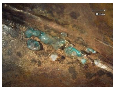
Figura 55 Aplicação de gel seco de EDTA em Esq_m1 (ver Anexo 2.2.)
