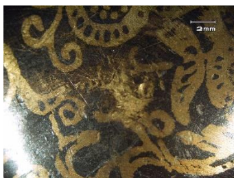
Figura 7 Pormenor desgaste de pátina e defeito de superfície
