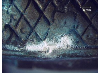
Figura 10 Pormenor corrosão suadouro (ver Anexo 2.2. Esq_m3)
