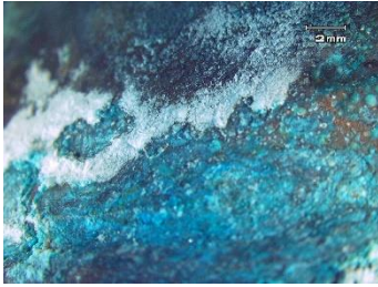
Figura 9 Pormenor corrosão pesçoço (ver Anexo 2.2. Esq_m1_z1)
