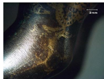
Figura 8 Pormenor desgaste de patina e riscos superficiais
