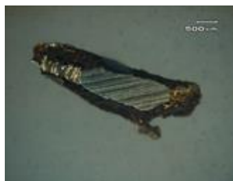
Figura 2 Amostra montada em resina durante o polimento
