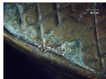
Figura 51 Antes da limpeza química com di-citrato de amónia
