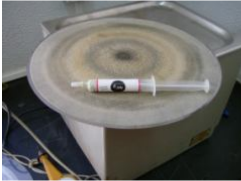
Pano com respectiva pasta de diamante de 6 \mu\text{m} .
