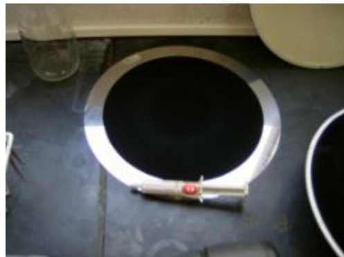
Pano utilizado com a solução OP-S.
