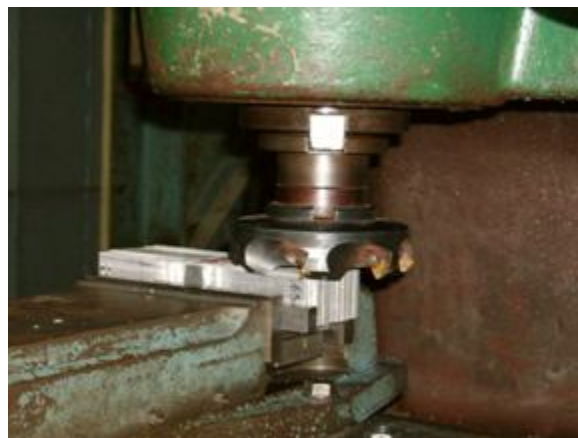
Etapa de corte para obter a geometria desejada.
