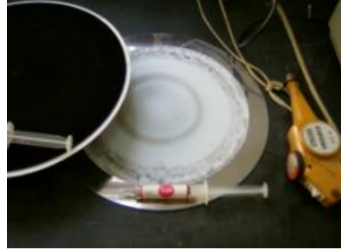
Pano com respectiva pasta de diamante de 3 \mu\text{m} .
