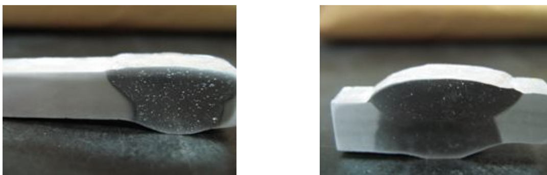
Figura 3.1– Porosidades visíveis nas amostras 6S6 e 5S4, respectivamente, contrastadas com reagente de Keller.
