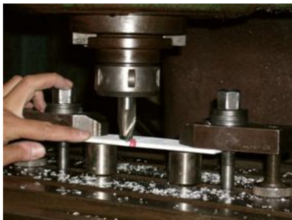
Etapa de afogamento do cordão.
