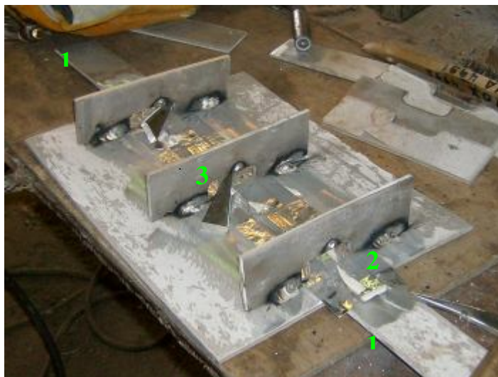
Provete com as respectivas chapas de início e fim de soldadura, cobre-junta e grampos de fixação.
