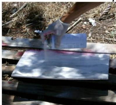
Aplicação do revelador.
