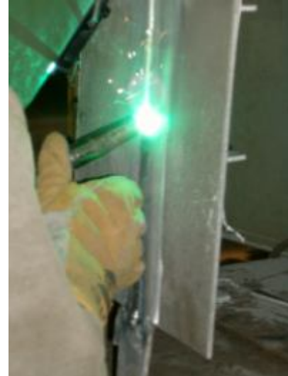
Soldadura ao baixo e vertical respectivamente.
