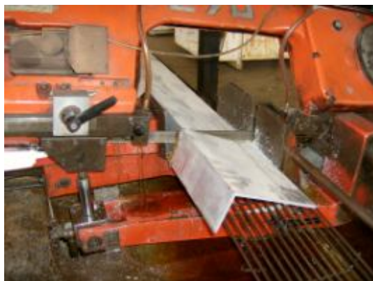
Figura 2.3 – Corte do perfil 6082-T6 de onde são retiradas as chapas.
