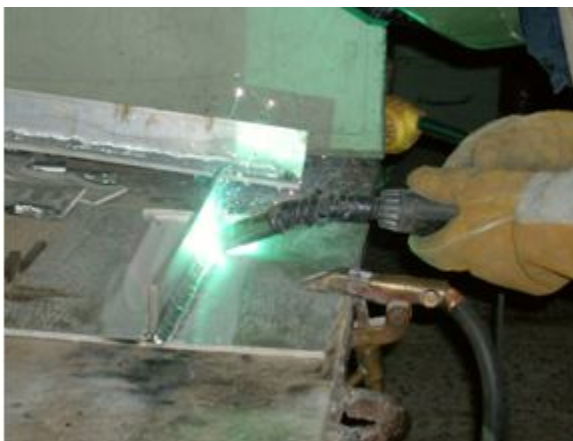
Soldadura de um provete com junta em T e um provete final.
