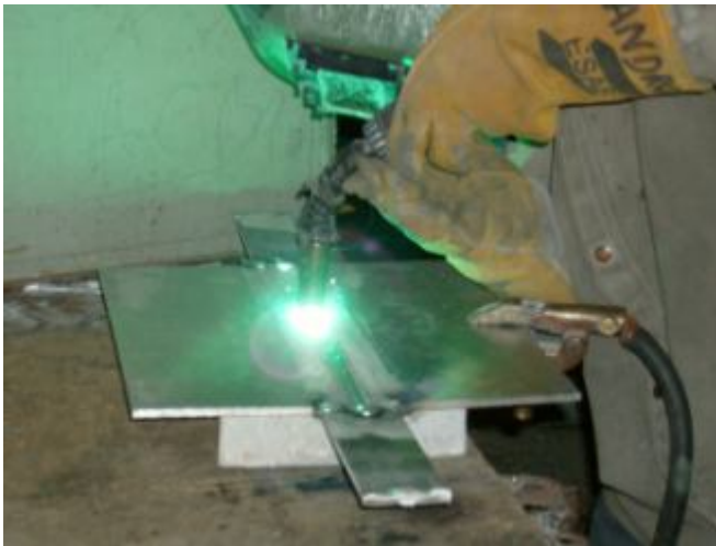
Soldadura ao baixo e vertical respectivamente.
