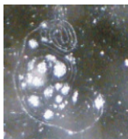
FIGURA 7 - Macrofotografia de obra em acrílico que apresenta despolimerização. Fonte: FRANÇA, 2008
