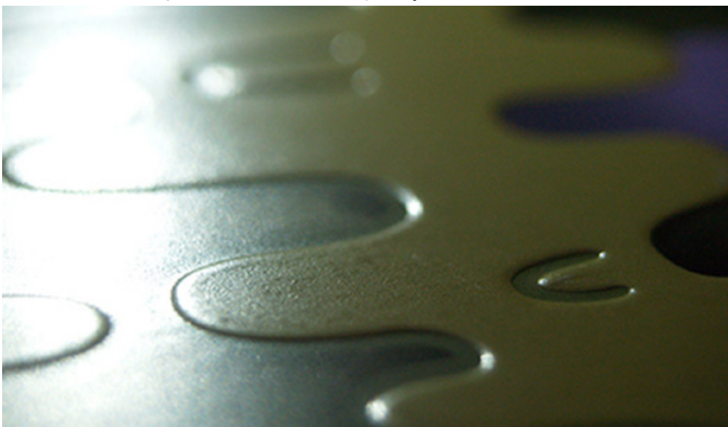
Figura 14: detalhe de aplicação de relevo seco.
