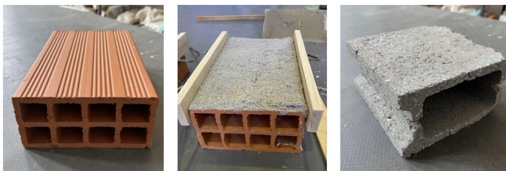
Figura 3. Suportes utilizados para o estudo da aderência: tijolo cerâmico, tijolo cerâmico com chapisco e bloco de betão
