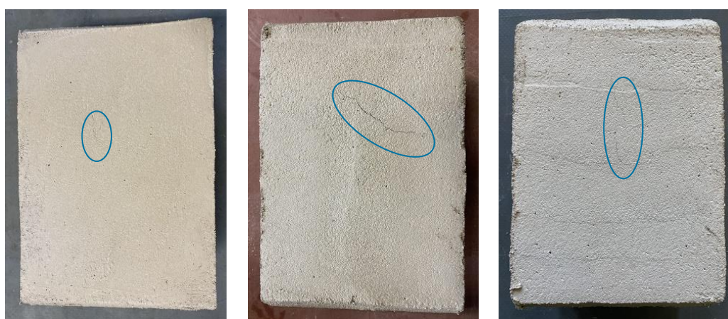
Figura 4. Observação da suscetibilidade à fissuração das argamassas: MRA100 aplicado em tijolo cerâmico; MRA100C aplicado em tijolo cerâmico e MRA100C aplicado em tijolo cerâmico com chapisco
