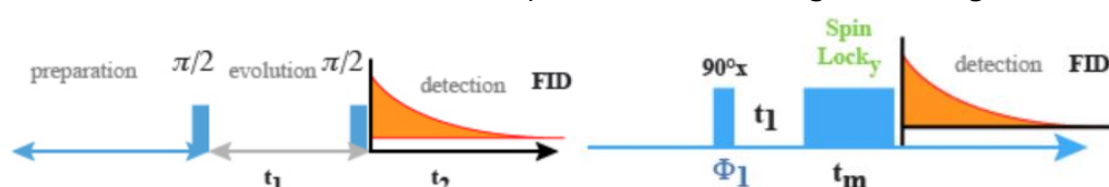
Figura A1. Pulsos de radio frequência numa experiência de COSY (à esquerda) e ROESY (à direita) 81
