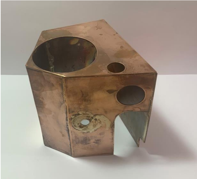
Vista de frente, sendo visíveis os recortes extra na abertura de passagem do feixe e na face voltada para o detetor gama.
