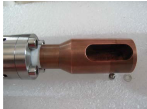
Figura 3.6: Gaiola de Faraday de cobre utilizada para medições de carga na linha de Reações Nucleares [38].
