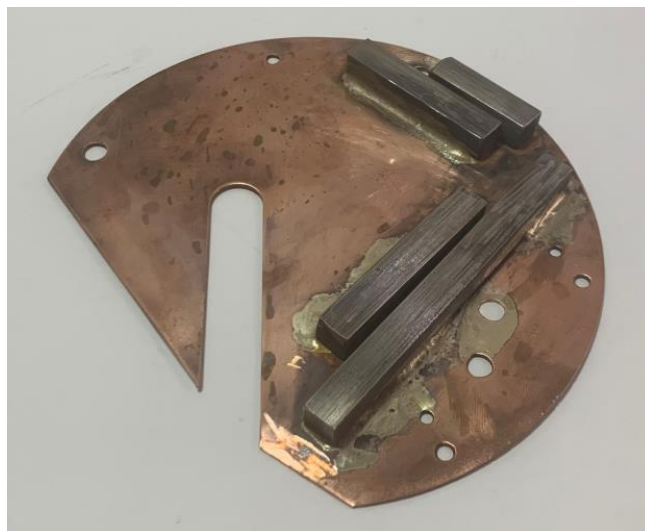
Encaixe soldado na base de cobre.
