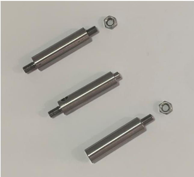
Os 3 pés da gaiola e roscas para fixação na base de aço.
