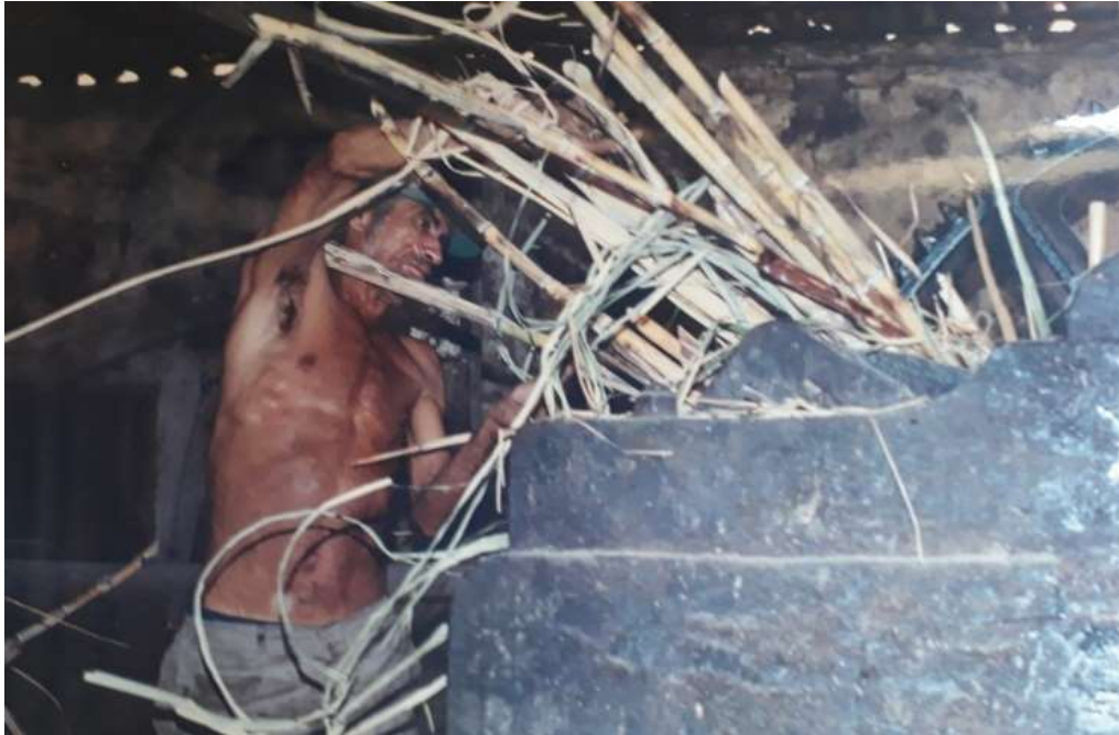
Figura 2.5 Metedor de cana colocando cana na moenda para extração do sumo. Fonte: Acervo de Henrique Lacordaire.
