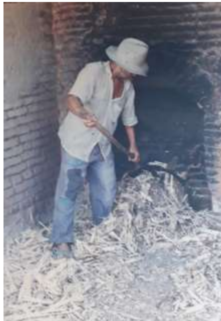
Figura 2.6 Bagaços de cana sendo colocados na fornalha. Fonte: Acervo de Henrique Lacordaire.
