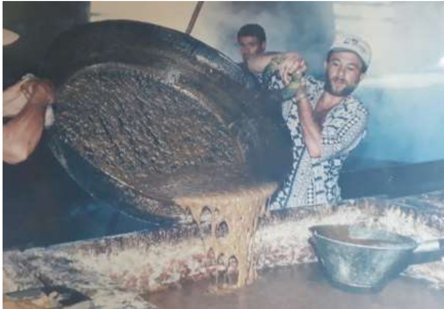
Figura 2.8 Mel sendo passado do tacho para a gamela para finalização seguida do caixamento. Fonte: Acervo de Henrique Lacordaire
