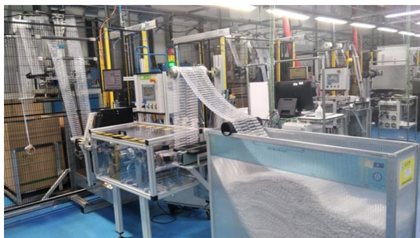
Figura 3.10 - Máquina de inspeção de qualidade das palhinhas.
