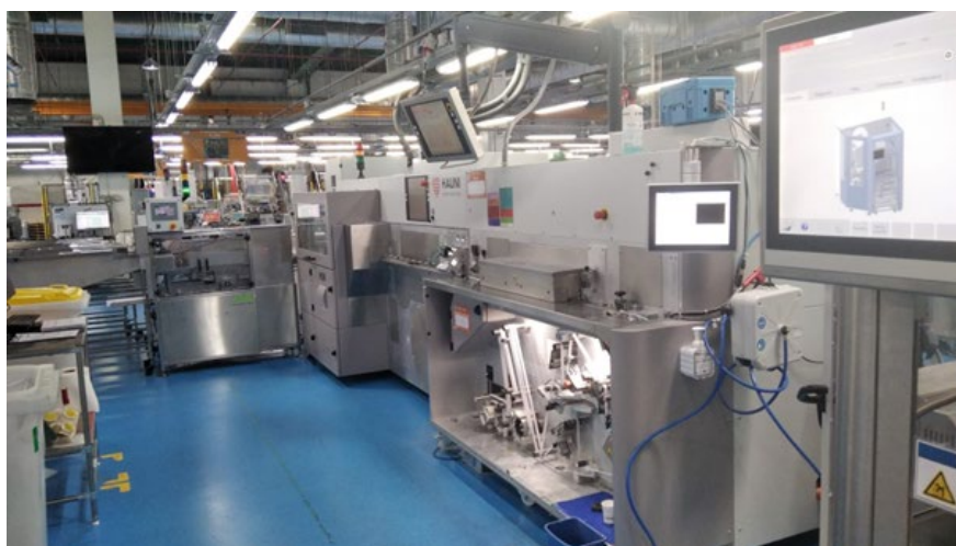
Figura 3.6 - Máquina responsável pela formação dos tubos de papel.
