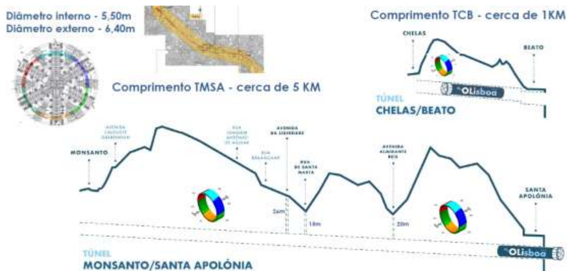
Figura 56 - Túneis de drenagem. Fonte: Camara Municipal de Lisboa, 2022
