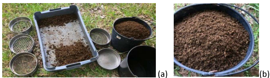
Figura 2 – Excremento bovino sendo peneirado após 7 dias secando (a) e após peneiração (b)
