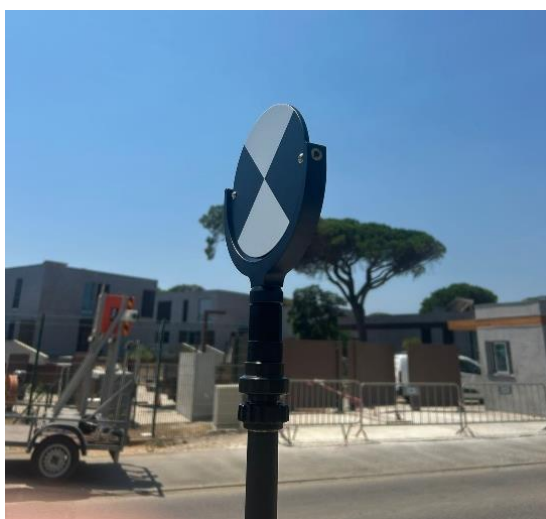
Figura 4.2 - Alvo de referência com duas partes brancas e duas partes pretas, utilizado para georreferenciação.
