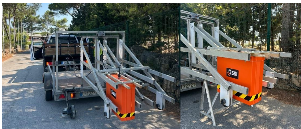
Figura 2.7 - Georadar no terreno (Caso de Estudo 2)
