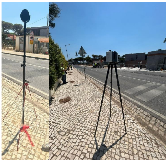
Figura 4.3 - Disposição do sensor LiDAR e do alvo na estrada durante o processo de aquisição de dados
