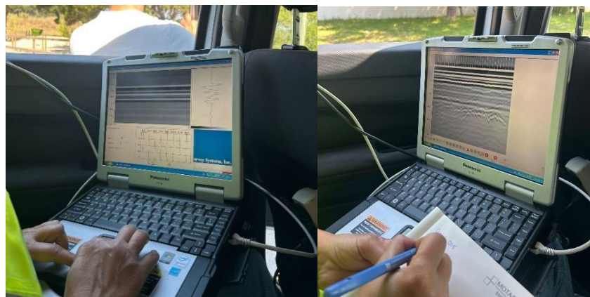
Figura 2.9 - Computador ligado e a receber informação do georadar (Caso de Estudo 2).
