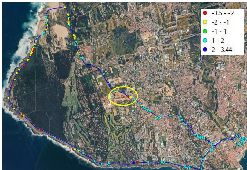
Figura 5.1 - Velocidades, em milímetros por ano, obtidas a partir do InSAR no trajeto de autocarro e identificação do troço estudado
