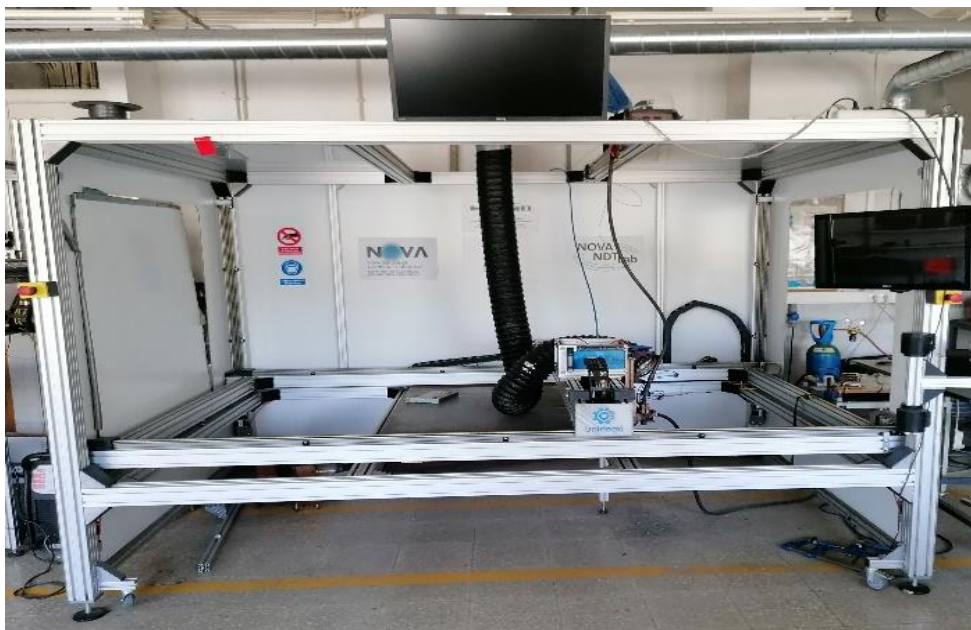
Figura 3.1 - Máquina de WAAM desenvolvida no DEMI.
