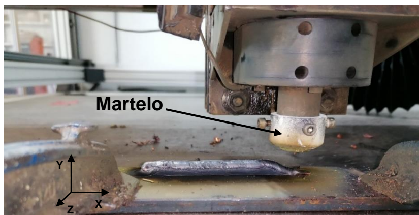
Figura 3.5 - Martelo de forjamento acoplado à tocha de soldadura durante a produção de uma parede de cobre.
