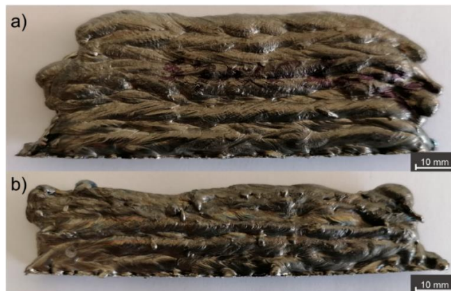
Figura 4.10 - Paredes finais de titânio: a) sem forjamento; b) com forjamento a quente.
