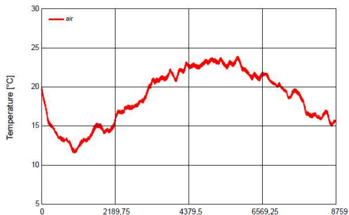
Figura 5.15 - Variação da temperatura do clima interior, por horas, ao longo do ano de referência. Captado através do programa WUFI Plus. “air” – temperatura do ar interior. Localização de Sines.
