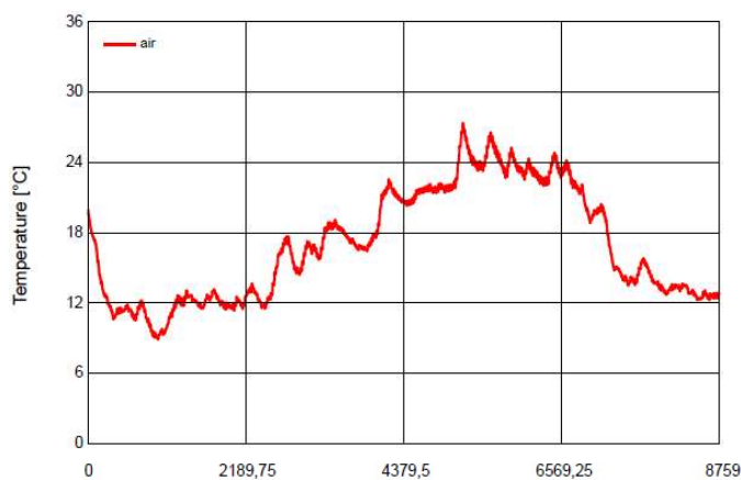
Figura 5.10 - Variação da temperatura do clima interior, por horas, ao longo do ano de referência. Captado através do programa WUFI Plus. “air” – temperatura do ar interior. Localização de Coimbra
