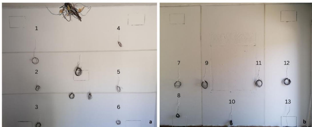
Figura 3.11 — Paredes interiores: oeste (a) e norte (b), com posicionamento de termopares.
