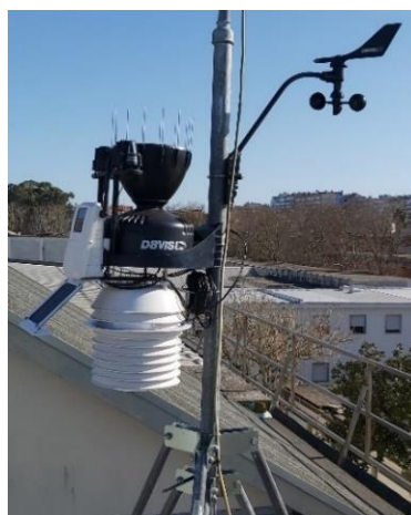
Figura 3.13 — Estação meteorológica instalada na cobertura do Núcleo de Revestimentos e Isolamentos do LNEC.
