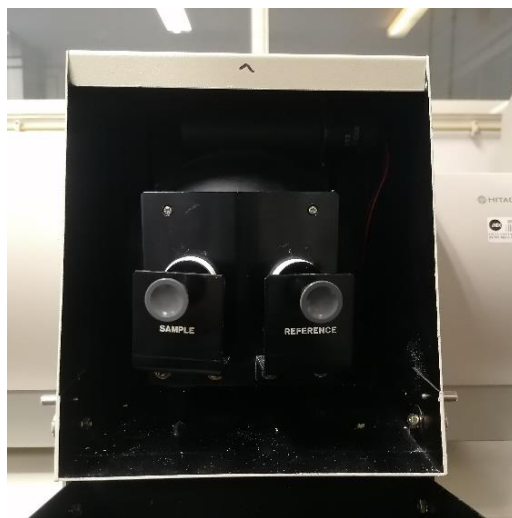
Figura 3.5 — Esfera integradora com duas amostras padrão de óxido de alumínio.
