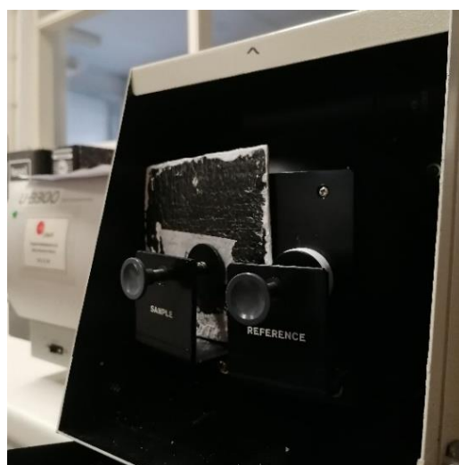
Figura 3.6 — Esfera integradora com a amostra revestida com tinta e amostra de óxido de alumínio.
