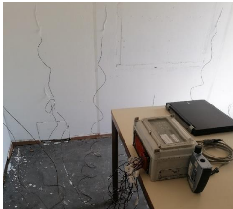
Figura 3.12 — Sistema de aquisição de dados no interior da célula experimental constituído por data logger e hydrolog .
