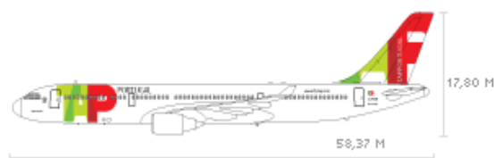
Figura 4.2 – Ilustração da aeronave A330 e respectivas indicações do comprimento e altura (Fonte: Empresa - Frota).
