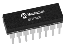
Figura 14 - Circuito integrado MCP3008. Reproduzido de [65].
