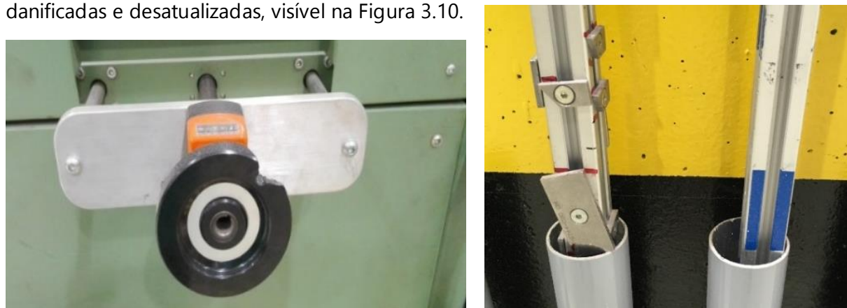
Figura 3.10 - Ferramentas de Set-up danificadas e desatualizadas
