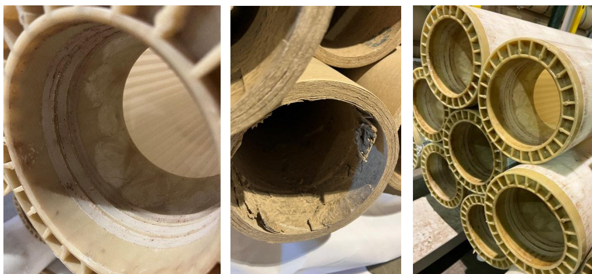
Figura 3.9 - Mandris e respetivas terminações desgastadas
