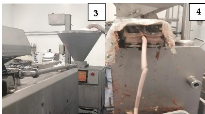
Figura 2.3 - Aspecto do cone (3) e da enchedora (4) utilizados no enchimento das tripas com a massa.
