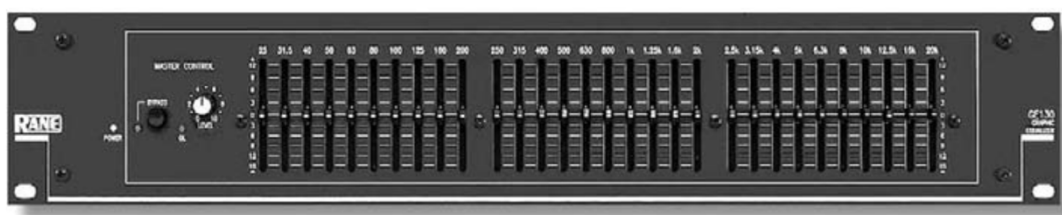
Figura 6: Equalizador gráfico de 30 bandas, com um canal (Huber e Runstein, 2010: 483).
