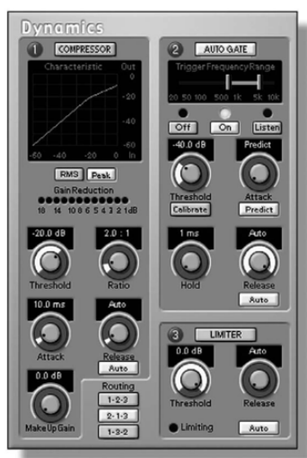
Figura 10: Processador dinâmico com compressão, limiter e gate (Huber e Runstein, 2010: 502).
