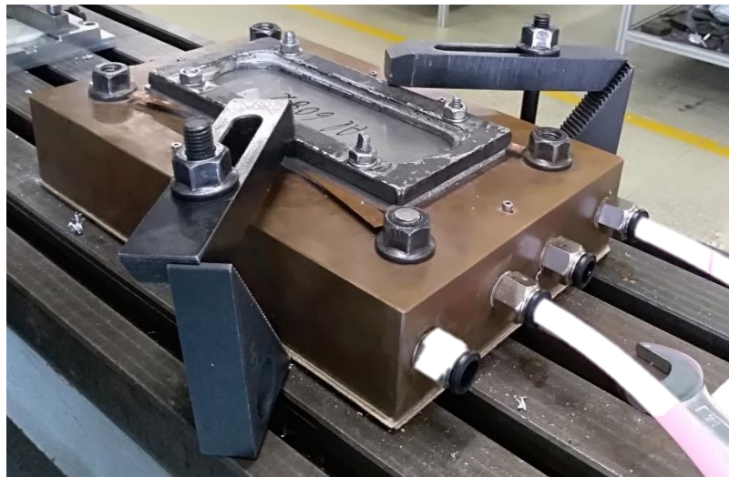
Figura 3.7 - Sistema de fixação com grampos nos ensaios de UFSP com a liga de magnésio
