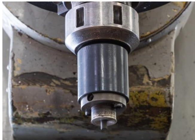
Figura 3.4 - Ferramenta montada na fresadora [30]
