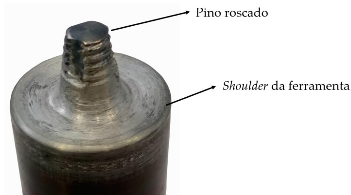
Figura 2.1 - Exemplo de uma ferramenta utilizada no PFL. [1]
