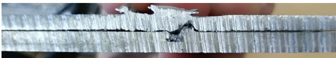
Figura 4.17 - Secção transversal da amostra produzida no ensaio 29, onde se percebe que não houve ligação das duas chapas.
