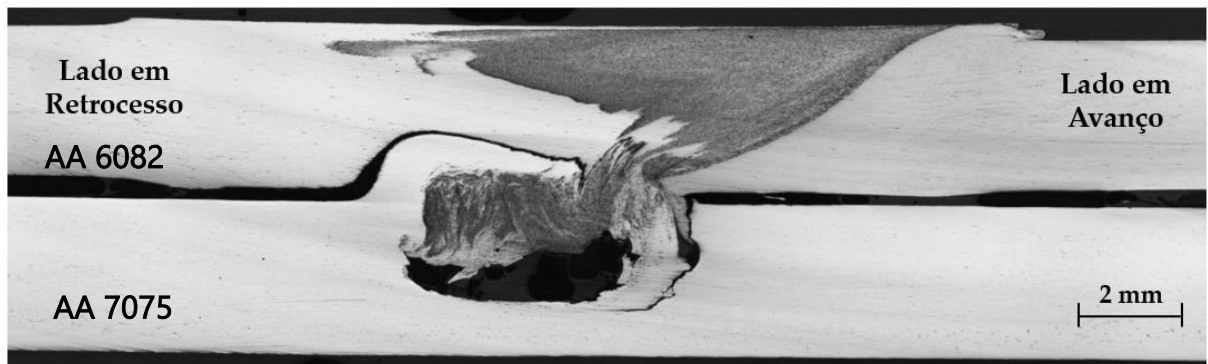
Figura 4.10 - Macrografia da amostra do ensaio 18
