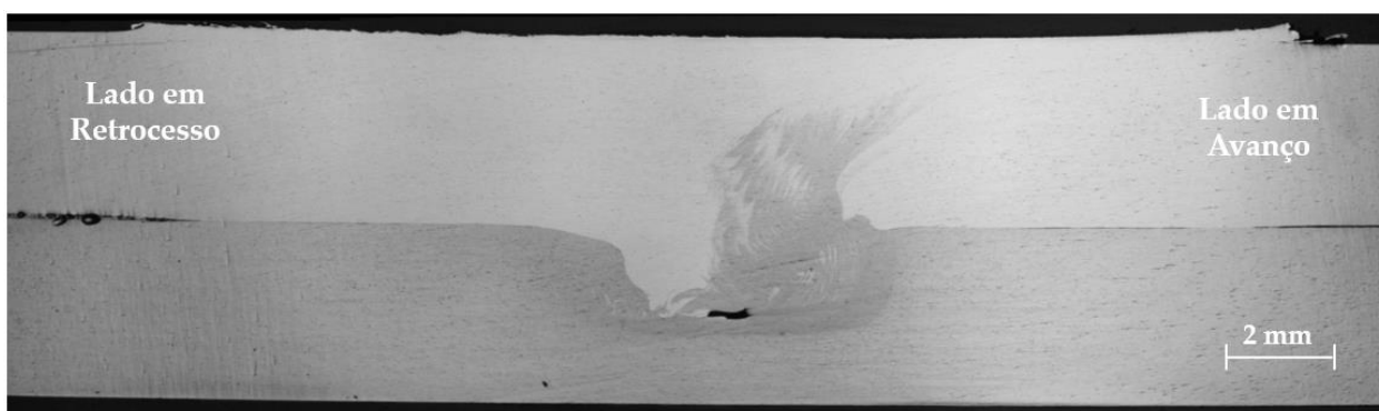
Macrografia da amostra do ensaio 13 não contrastada
