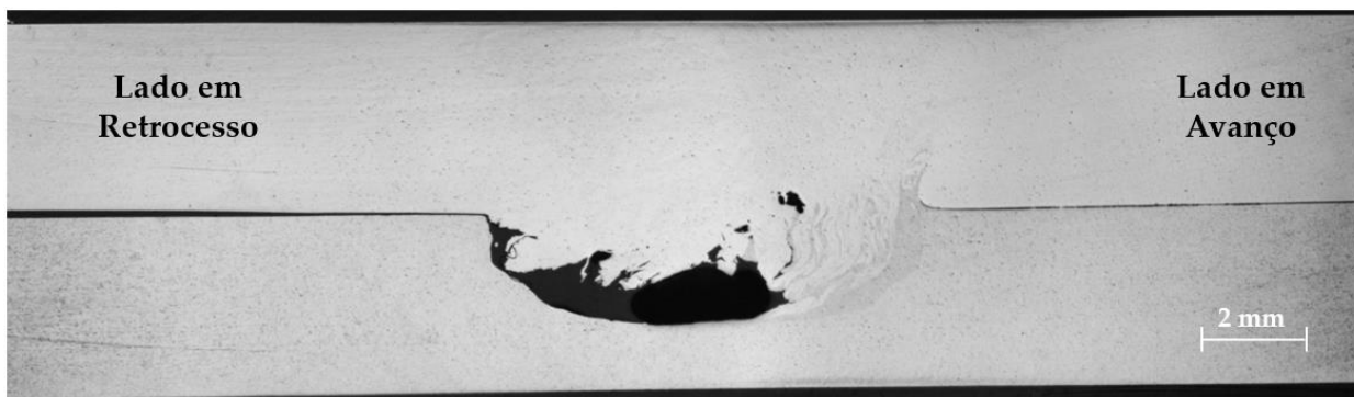
Macrografia da amostra do ensaio 20 não contrastada
