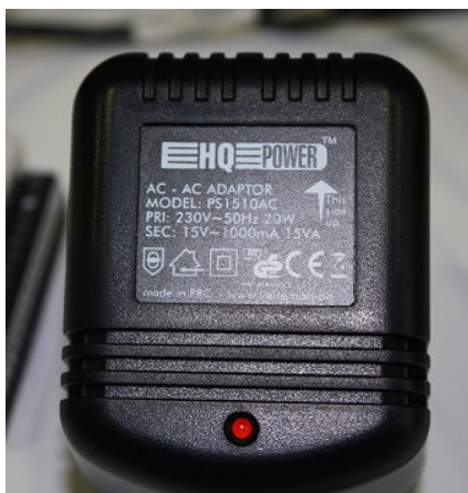
Figura 3.11 - Transformador redutor - AC/AC, 230V/15V.
