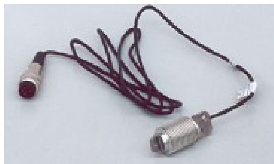
Figura 4.3 - Sensor de Carga DL 2006E, De Lorenzo Group [14].
