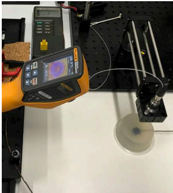
Figura 6.67: Imagem dos dois instrumentos Termómetro de IV e Termopar durante a experiência C.1. Na imagem é visível o fio do Termopar a atravessar o fantoma e a entrar no absorvedor.
