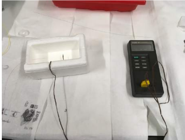
Figura 1: Imagem do setup experimental utilizado para realizar a caracterização em temperatura dos sensores de fibra óptica. Na imagem é visível o recipiente de esferovite onde é introduzida a água, a extremidade sensora do sensor de fibra óptica MMI numa lateral do recipiente e numa outra lateral o termómetro Termopar.
