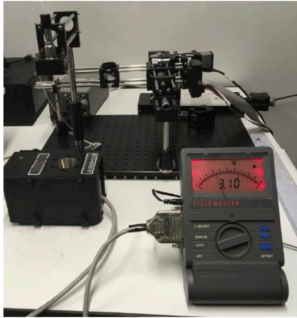
Figura 1: Imagem do potenciômetro utilizado para medir a potência do feixe laser incidente. O feixe laser incide no detetor do potenciômetro e este converte a radiação num valor de potência mostrado analógica e digitalmente no visor do mesmo em Watts.
