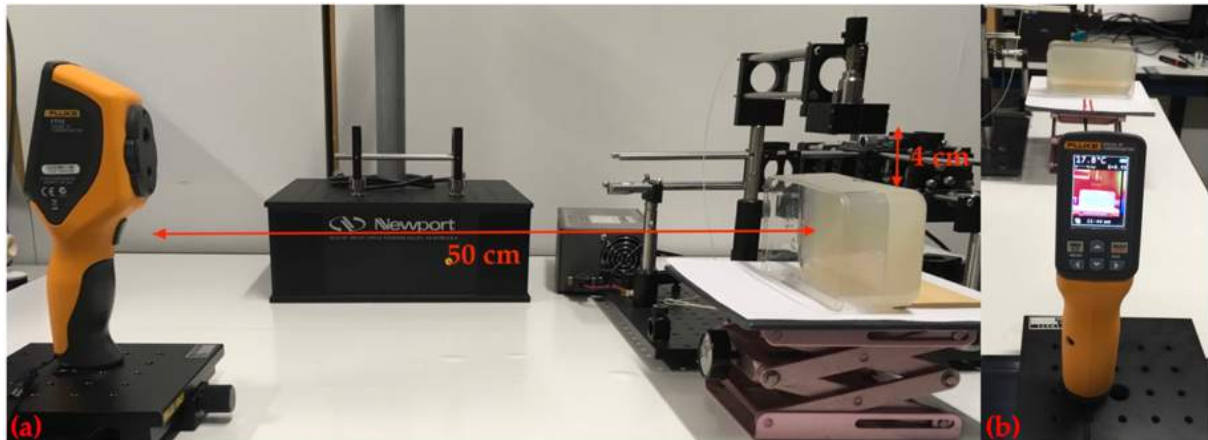
Figura 5.1: Imagem do setup experimental escolhido para estudar o fantoma A.1. A imagem (a) mostra a disposição do Termómetro de IV em relação à superfície de leitura da temperatura e de registo do termograma. Na imagem (b) vemos o termograma da superfície do fantoma na qual se realiza a leitura de temperatura no ecrã do Termómetro de IV.
