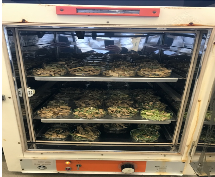
Figura 3-5: Processo de secagem da biomassa fresca na estufa
