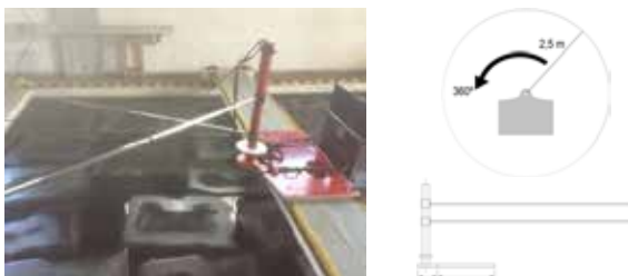
Figura.6. Imagem e esquema técnico da estrutura para suporte de equipamentos acústicos e do alvo.
