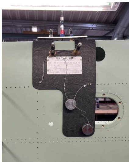
Figura 3.24. Ferramenta original de esboço para o recorte do revestimento
