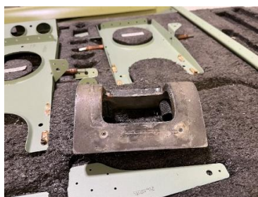
Figura 3.23. Gabarito de recorte do revestimento
