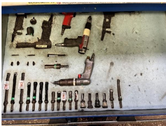
Figura 3.16. Organização em shadowboard das ferramentas do posto
