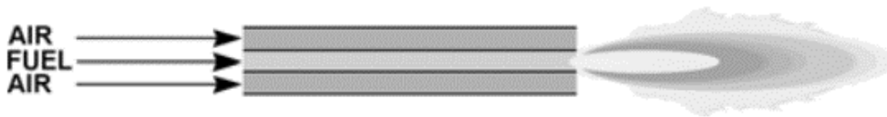
Figura 1.4: Queimador sem pré-mistura. (Baukal, 2000).
