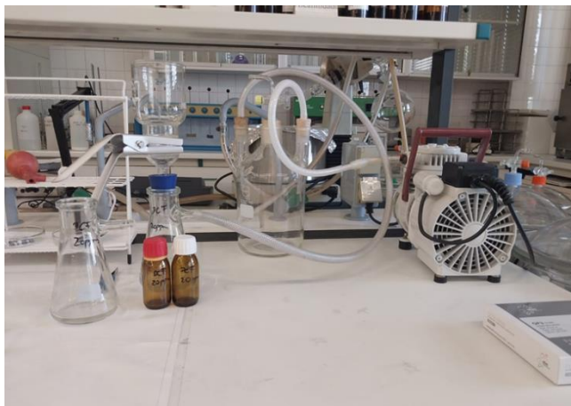
Figura 2.1: Sistema de Filtração
