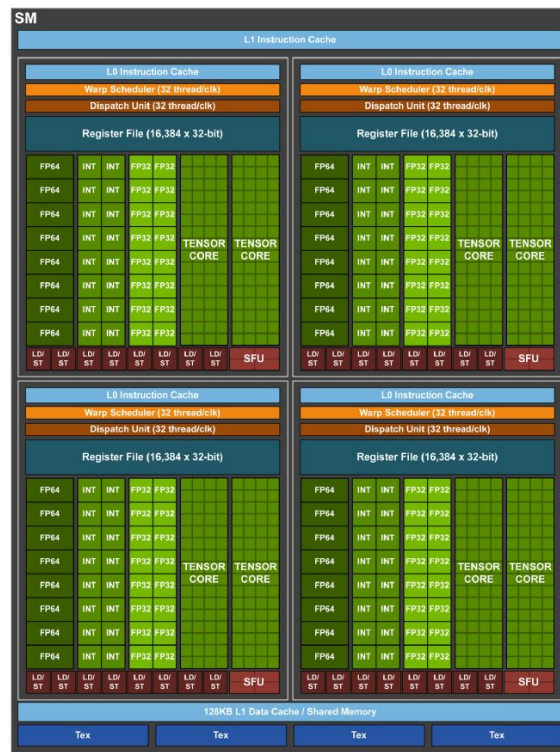
Figura 2.2: Esquema de um SM da GPU NVIDIA Volta GV100 [37].
