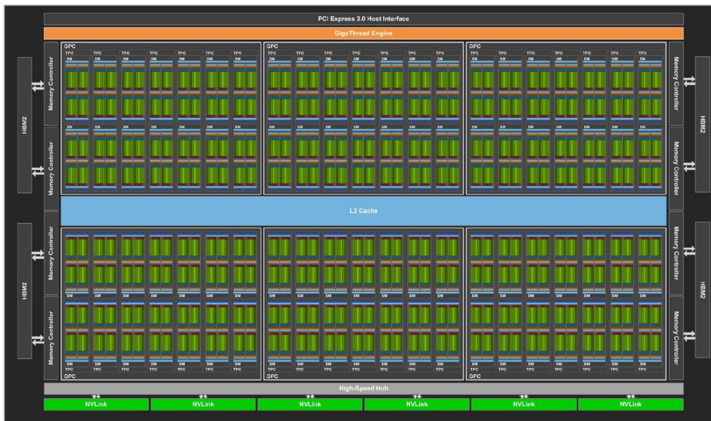
Figura 2.1: Esquema da GPU NVIDIA Volta GV100 com oitenta e quatro Streaming Multiprocessors (SMs) [37].
