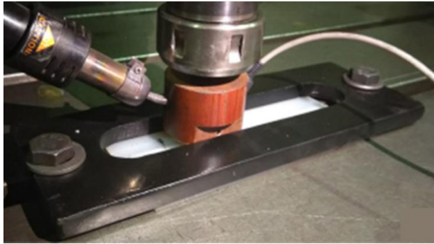
Figura 2.17 - Ferramenta de shoulder estacionário com aquecimento externo por pistola de ar quente, [30].
