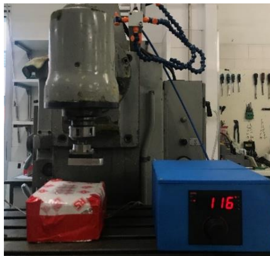
Figura 3.12 - Montagem do aparato experimental para aquecimento da base do sistema de fixação até 165°C.
