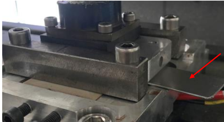
Figura 3.11 - Ensaio de SFL com o bloco de nivelamento colocado.
