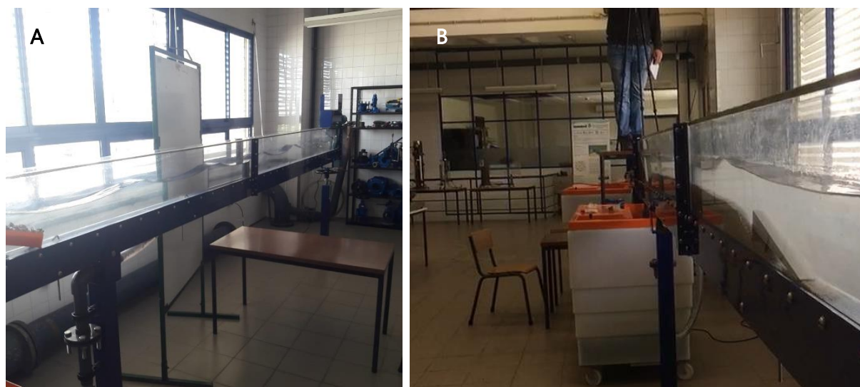
Figura 3.2- Canal de laboratório, durante ensaios de (A) fundo fixo e (B) fundo móvel.
