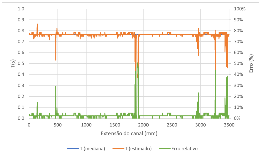
Figura 4.104- Valores medianos e estimados de T e erro relativo para o ensaio da altura de onda, para uma distância ao eixo do disco de 3,0 cm.
