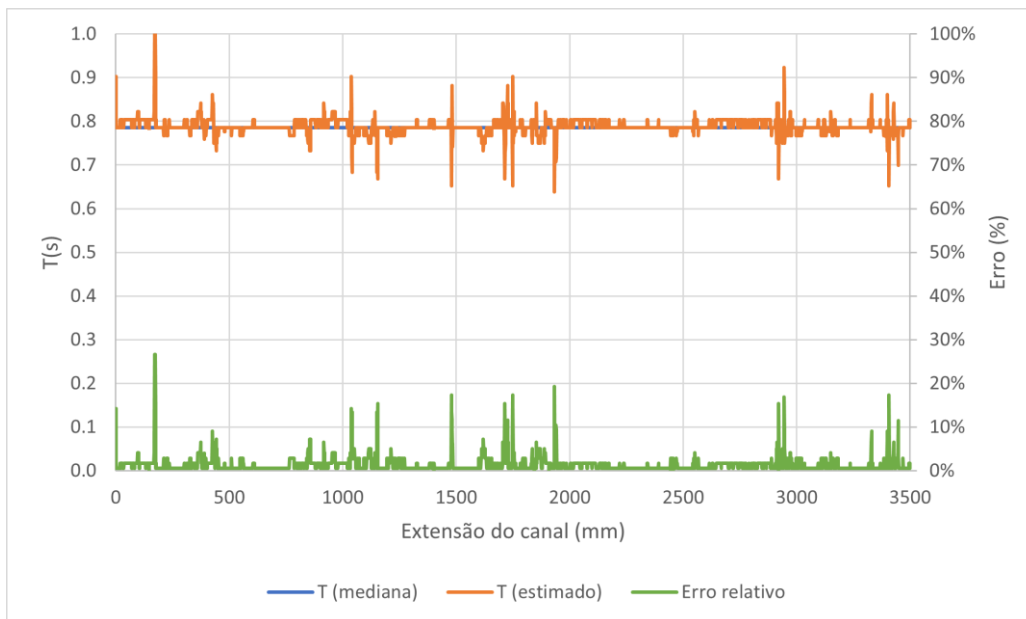
Figura 4.64- Valores medianos e estimados de T e erro relativo para o ensaio de profundidade de 15,2 cm.
