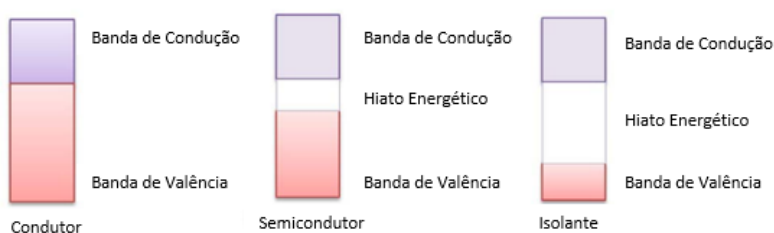
Figura 2.7: Camadas de valência e de condução, e intervalo entre bandas (GAP) (Adaptada de Sampaio e González (2017)).
