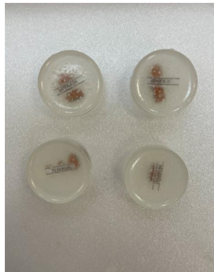
Figura A.6.41 - Amostras feitas para as análises de Raman
