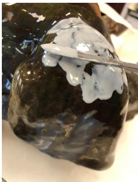
Figura 2.6 - Aplicação do silicone líquido na peça MRBP.CER.0904
