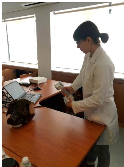
Figura 2.9 - Digitalização da linha de fratura MRBP.CER.0499
