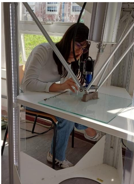
Figura A.6.19 - Ajustes feitos durante o momento da impressão em argila
