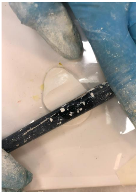
Figura A.6.30 - Modelação do Milliput®
