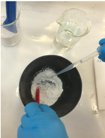
Figura A.6.14 - Mistura de água com gesso para obter a pasta
