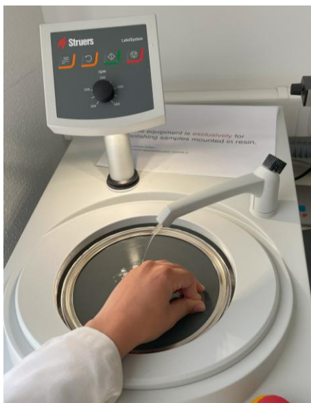
Figura A.6.42 - Polimento das amostras
