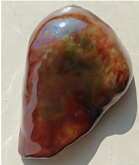
Figura 2.44 - Orelha de barro vidrada na Fábrica BP depois da cozedura
