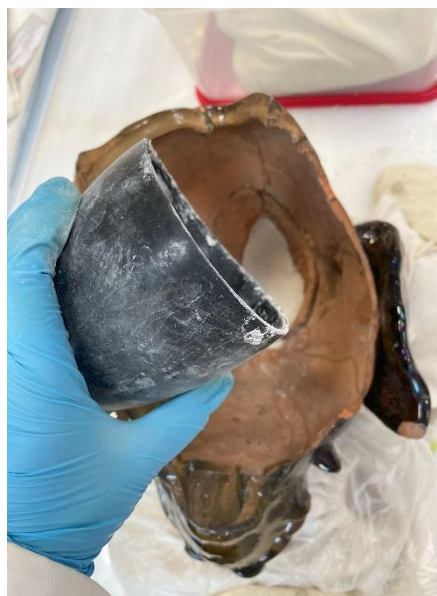
Figura 2.26 - Aplicação do gesso no molde
