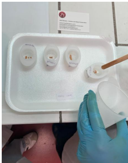
Figura A.6.40 - Colocação da resina epoxídica nas amostras
