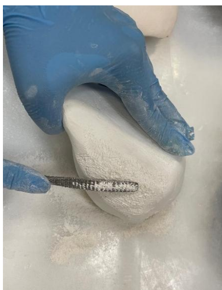
Figura 2.5 - Reajustes feitos no gesso, utilizando uma grosa
