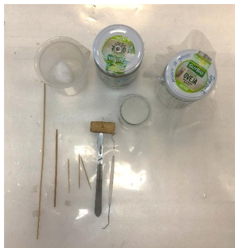
Figura 2.2 - Materiais usados na limpeza
