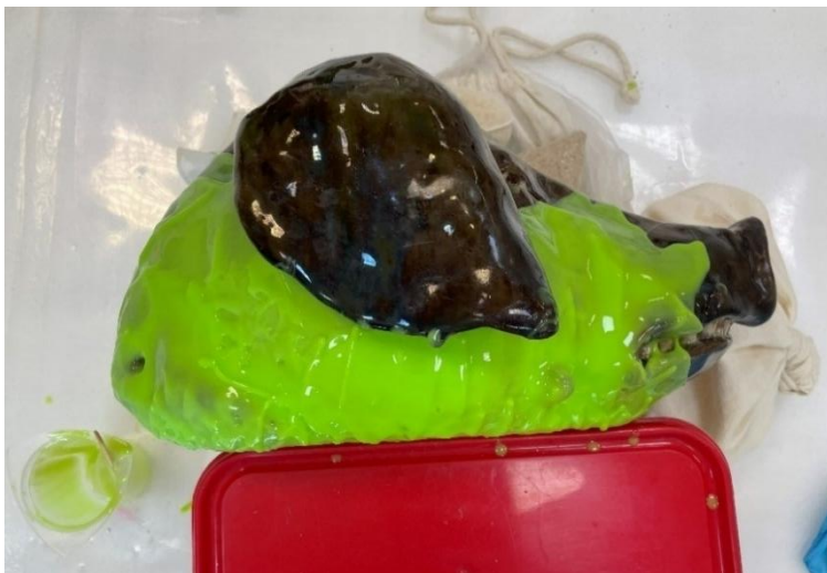
Figura 2.28 - Molde de silicone feito na peça MRBP.CER. 0499
