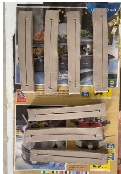
Figura A.6.23 - Provetes para testes de contração do barro
