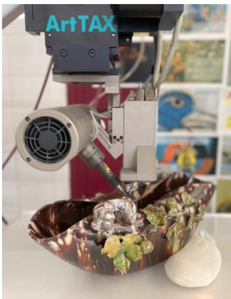
Figura A.6.43 - Análises de XRF feitas na peça MRBP.CER.0289
