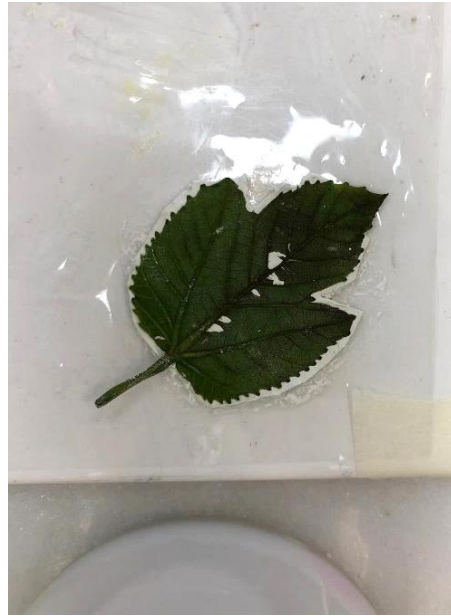
Figura 2.33 - Folha prensada na massa epóxidica
