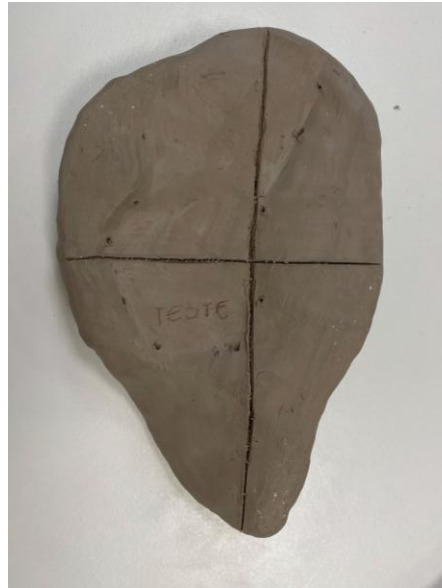
Figura A.6.25 - Fragmento de teste feito para calcular a contração do barro na cozedura
