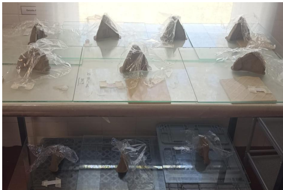
Figura A.6.20 - Secagem dos fragmentos impressos em argila
