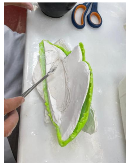
Figura 2.29 - Aplicação do gesso no molde
