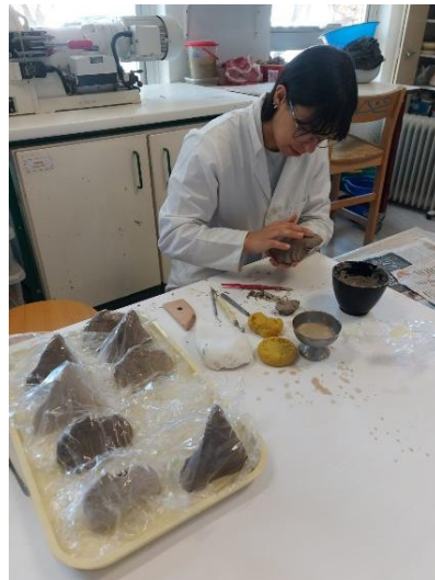
Figura 2.21 - Processo de união das duas partes dos elementos impressos
