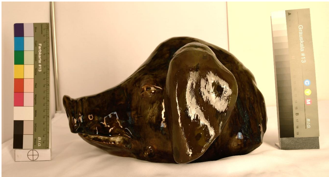
Figura 2.42 - Resultado da orelha de PLA
