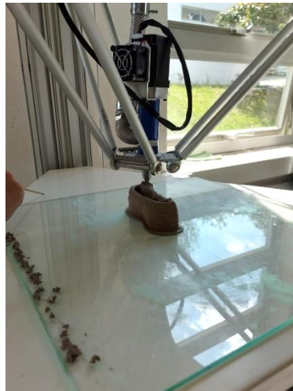
Figura 2.18 – Momento da impressão de um dos fragmentos obtidos
