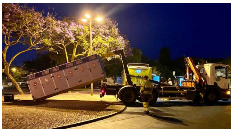
Figura 5-13 – Processo de reboque da infraestrutura de ecocentro móvel para posterior transporte para a próxima localização
