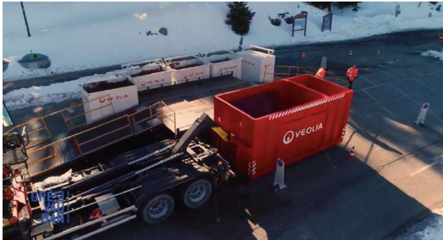
Figura 2-8- Infraestrutura de “Déchettàrie mobile” (Fonte: LeGrésivaudan, 2020)
