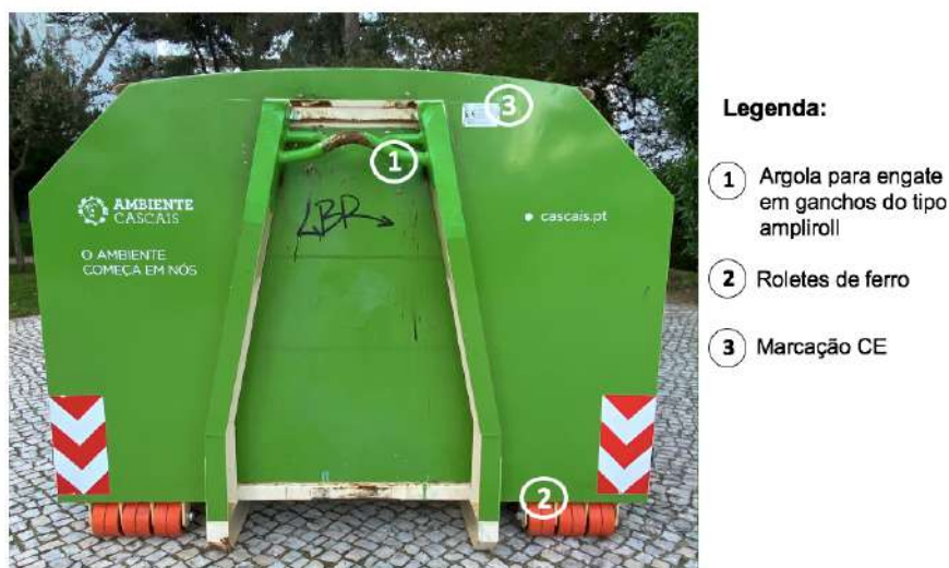
Figura 5-3 – Infraestrutura de ecocentro móvel (face traseira): componentes e respetiva legenda
