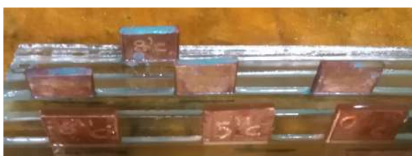
Figura 3.13 - Aparecimento de verdetes nas amostras sem inibidor.
