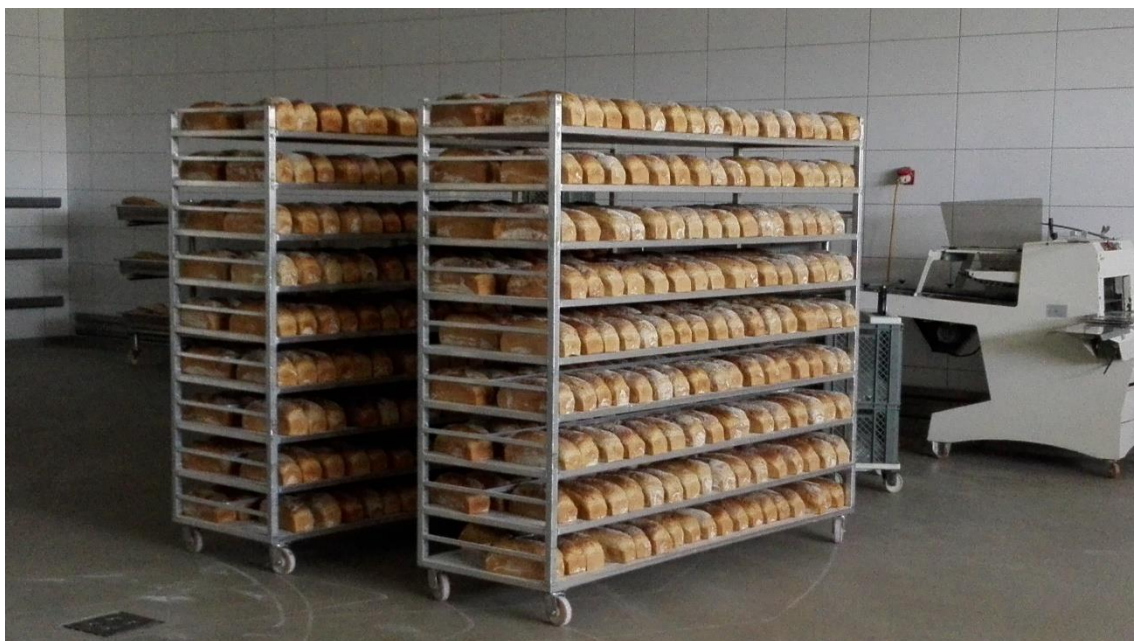
Pão de Forma de Mafra arrefecendo nos carros perfurados em zona climatizada
