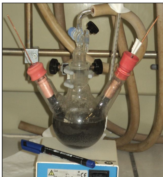
Figura 8 - Compartimento da célula com os respectivos eléctrodos e electrólito.
