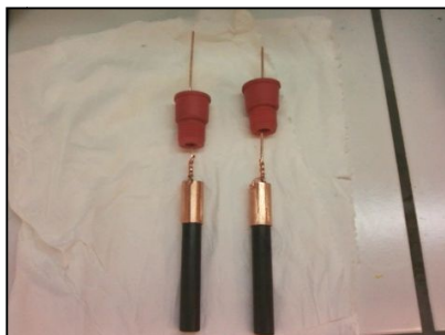
Figura 7 - Eléctrodos de grafite com ligações em cobre e respectivas subas.
