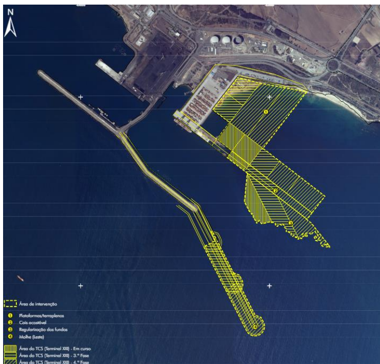
Figura 32 - Expansão do quebra-mar leste do molhe leste e do terminal XXI (Adaptado de: [21])
