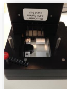
Figura 3.5 - Processo de impressão de slides com recurso a arrayer manual. Slide constituídos por 2 blocos de nitrocelulose
